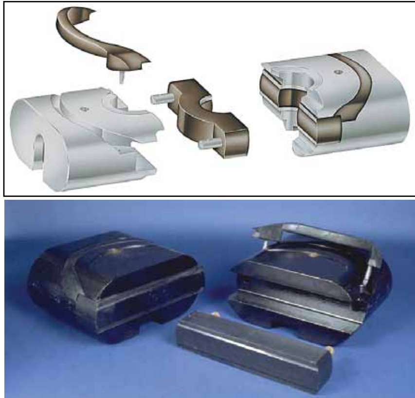
Figura 9.7. Bloques de ariete de tubería y bloques del ariete ciego.
