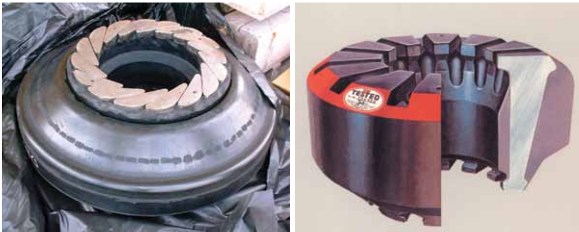
Figura 9.3. Un ejemplo de los elementos de sellado de BOP.
