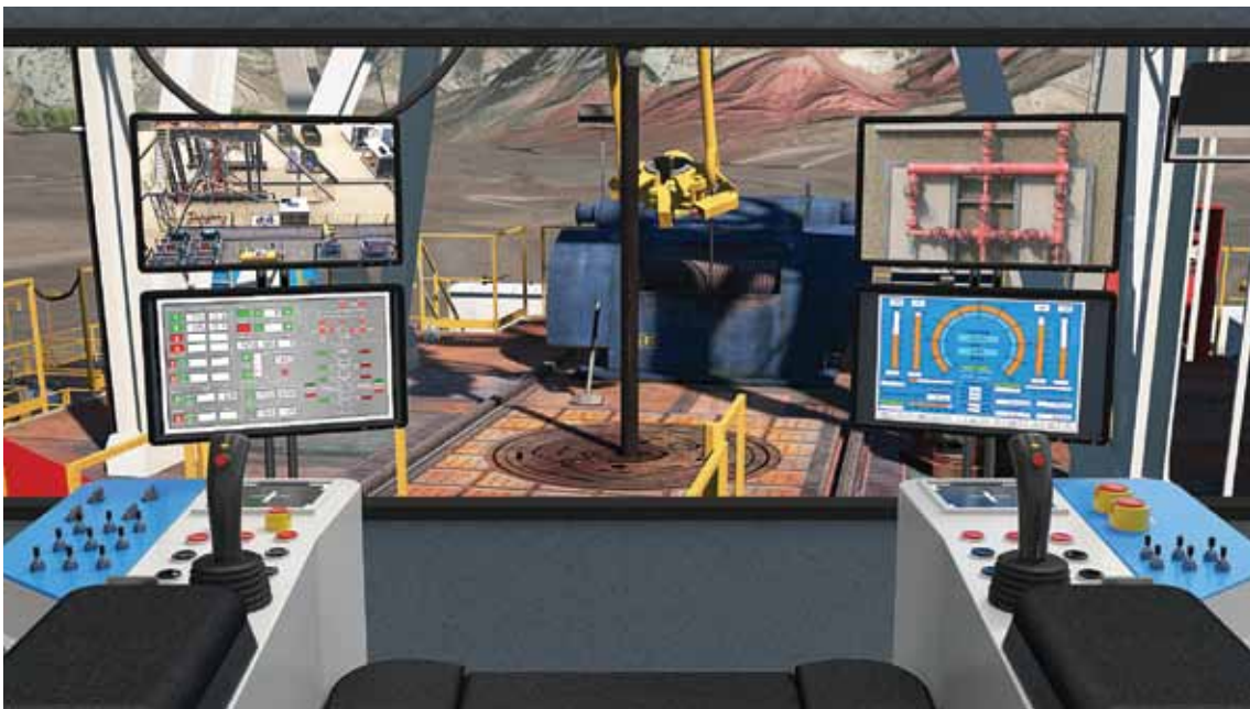
Figura 9.29. Abajo: imagen del Sistema de control de pozo escuela 21 del curso de capacitación en línea que ilustra cómo las plataformas modernas le brindan al perforador mucha información.
