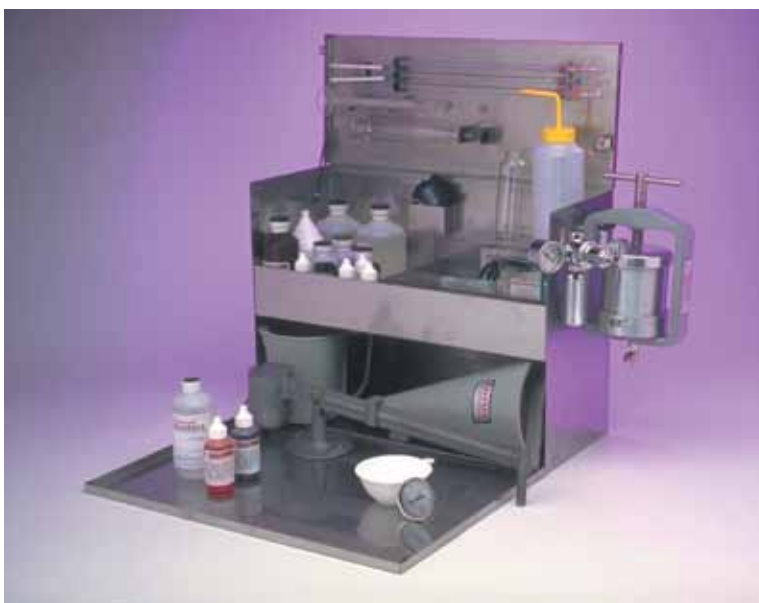
Figura 2.1. Laboratorio de análisis de campo con balanza para lodo.
